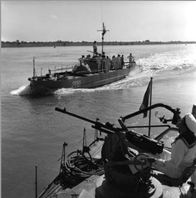
Поглед на РОЧ-200 преко крменог противавионског оруђа РОЧ-201 – уместо изворног наоружања, произведеног у СССР-у, приликом реконструкције јесте на тај чамца уграђен ПАТ 20 мм италијанске фирме „Бреда“
