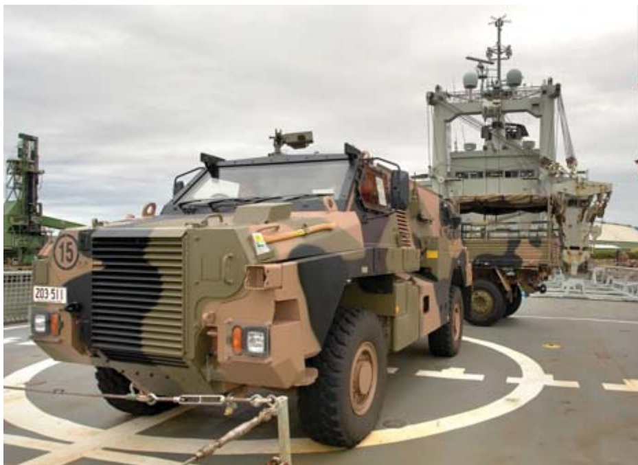
Шасија је нове концепције са дном у облику слова „V” која возило доста одиже од тла
