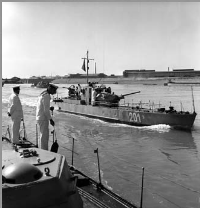
Оклопни чамец ОКЧ-201 на дефилеу Речне ратне флотиле. У предњем плану види се крма РОЧ-200 са шестоугаоном куполом, карактеристичном за касне серије Т-34-76
